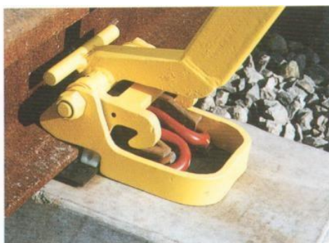
图 G.3 弹条拆卸示意
